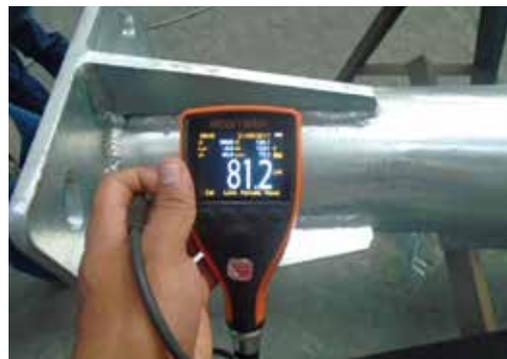
b) Medición de espesores del recubrimiento galvanizado
