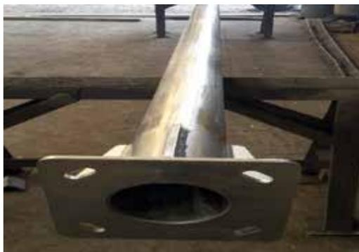
a) Poste de iluminación galvanizado de espesor de acero 5 mm
