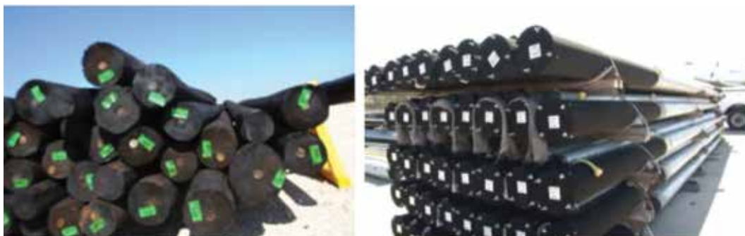
Imagen 16. Los postes de madera difieren en peso y tamaño, además de expandirse y contraerse debido al calor y humedad, por otro lado los postes de acero GIC son consistentes en tamaño y resistencia. [33]
