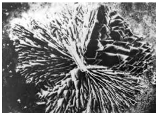
Fig.5. Cristales de \text{CaHZn} (Hidroxizincato de Calcio) en una solución saturada de \text{Ca}(\text{OH})_2 , \text{pH}=12.6 , 160X. [27]
