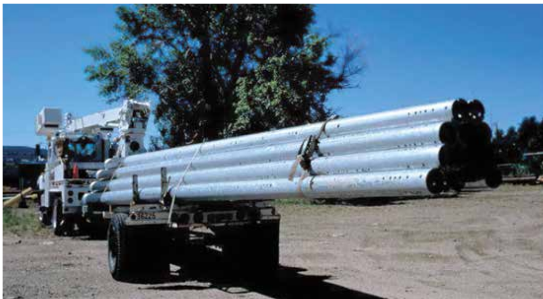
Imagen 14. Los postes de acero GIC se transportan de manera más sencilla que los postes de madera. [33]
