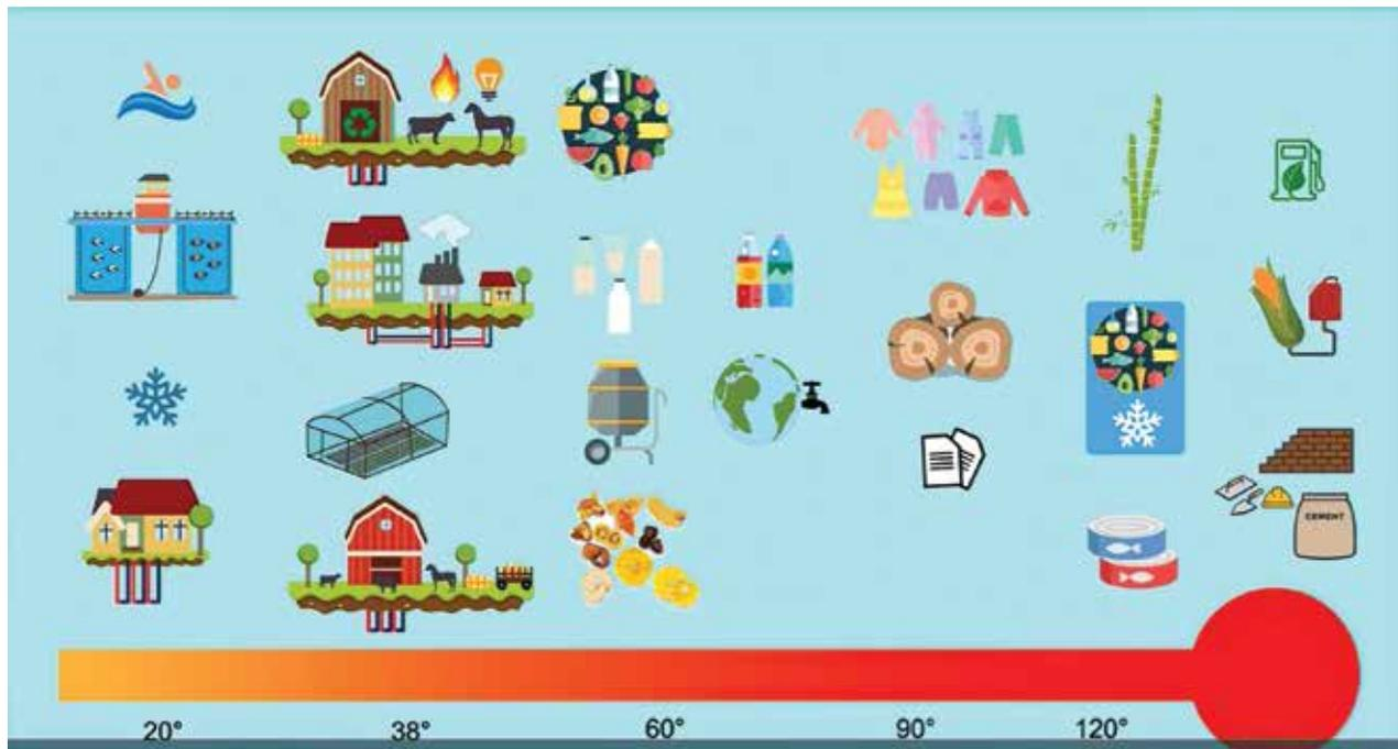
a. Diagrama de Lindal: utilización de la energía geotérmica y calor (CECACIER, 2023)
